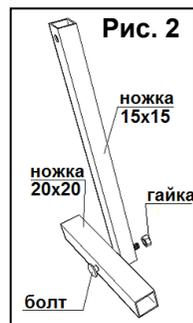
3. Соберите четыре Т-образных ножки. Для этого соедините между собой два отрезка трубы 15x15 мм и 20x20 мм (рис. 2), которые находятся в коробке с фурнитурой. Вставьте ножки внутрь трубы по углам каркаса, предварительно выкрутив болты с нижних отверстий. Для этого удобнее будет перевернуть собранный каркас в горизонтальное положение. Установите ножки и закрепите их теми же болтами, которые были выкручены ранее. После установки ножек стяните все узлы креплений до упора.
