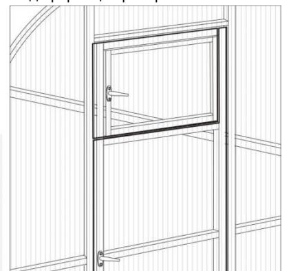
Строительным, либо обычным острым ножом обрезать выступающие части поликарбоната за арочную часть, затем прорезать проем форточки и двери и прорезать поликарбонат на петлях, чтобы он не мешал открыванию и закрыванию двери и форточки.
