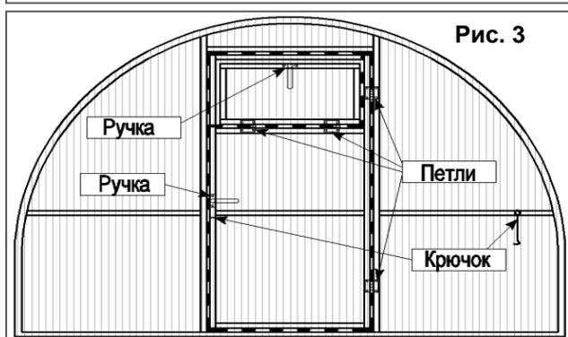
4. Установите петли на дверь и форточку с помощью саморезов. Все петли должны находиться снаружи поликарбоната. Прикрутите саморезами ручки на форточку и дверь, как показано на рисунке 3.
