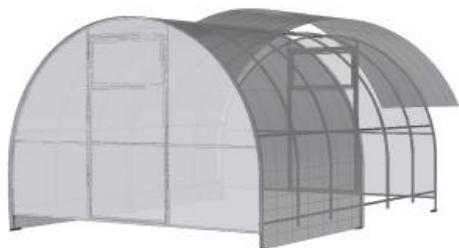
Перед началом работ следует тщательно выровнять площадку, на которой будет стоять теплица. Прокопайте траншею по всей длине теплицы с обеих сторон, глубиной не менее длины Т-образной ножки. Опустите каркас в траншею, чтобы Т-образные ножки вошли в нее полностью, а нижняя планка торца была на одном уровне с землей. Выровняйте каркас теплицы с помощью строительного уровня и закрутите все его болтовые соединения до упора.
