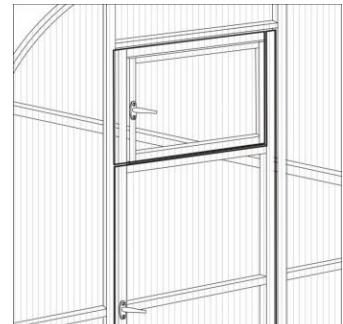
Строительным, либо обычным острым ножом обрезать выступающие части поликарбоната за арочную часть, затем прорезать проем форточки и двери и прорезать поликарбонат на петлях, чтобы он не мешал открыванию и закрыванию двери и форточки. Ручки для дверей необходимо закрепить при помощи саморезов ПШС, либо болтами, предварительно просверлив отверстия
