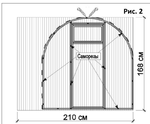
5.1.3. Установите петли на дверь и форточку с помощью саморезов. Все петли должны находиться снаружи поликарбоната. Прикрутите саморезами завертки на форточку и дверь, как показано на рисунке 3.
