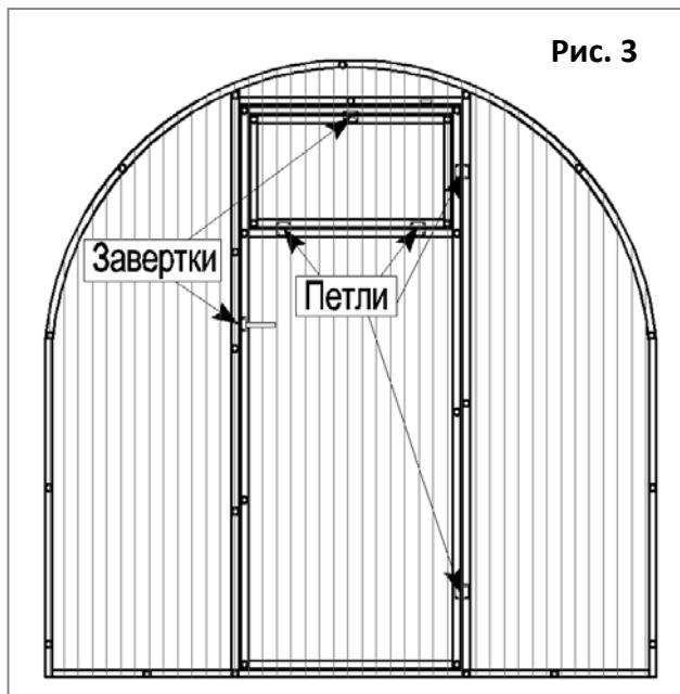
5.1.7. Установите крючки на внутренней стороне дверей, а проушины для крючков на внешней стороне торцов, согласно просверленным отверстиям.
